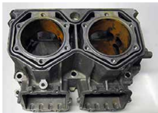
Gammalt plasmacylinderblock med rostbeläggning
